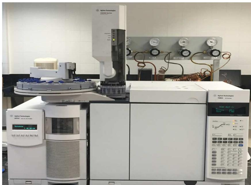
**Figura 12.** Cromatógrafo Gasoso acoplado à Espectrometria de Massa (CG – MS)
